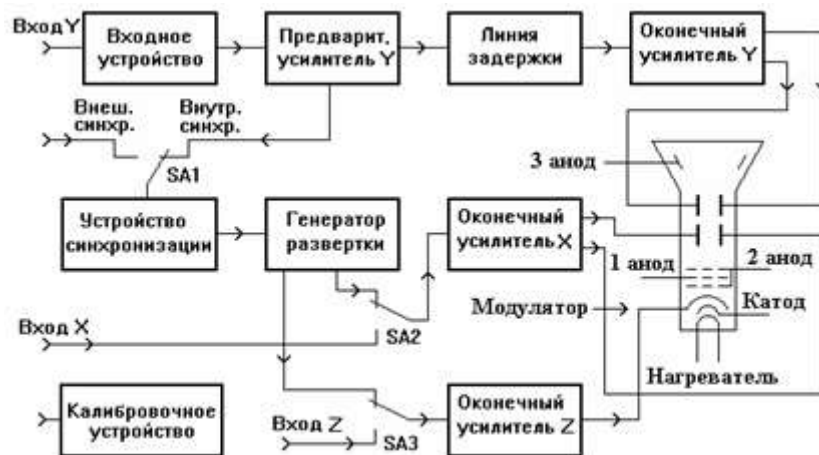
Рис 5.2. Структурная схема осциллографа.
